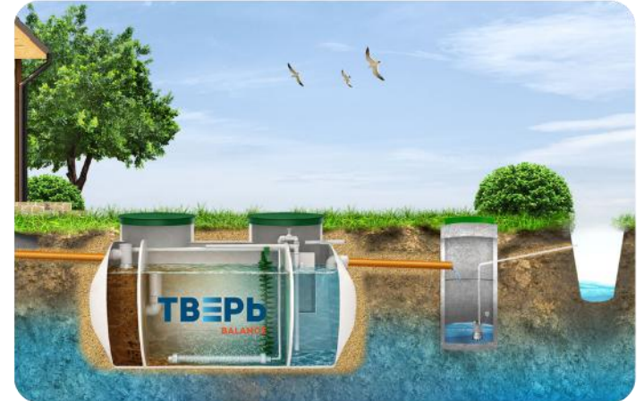
Самотечный сброс в накопительный колодец и оттуда принудительный выброс в канаву
