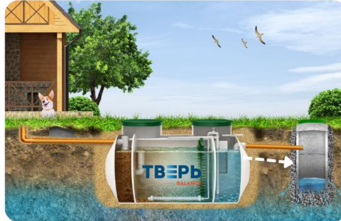
Отвод в дренажный колодец
